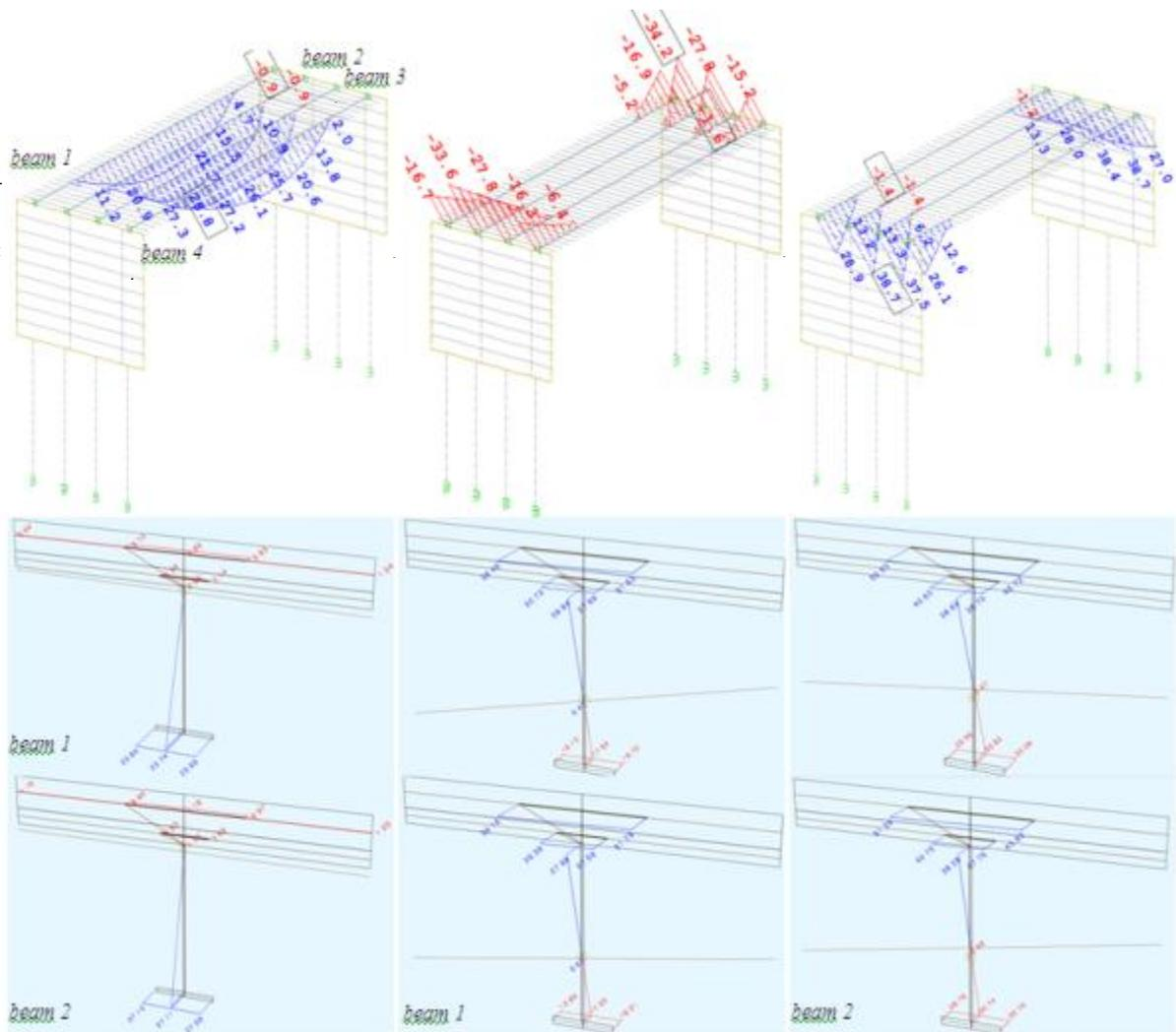
Figure 112 - „S<sub>design</sub>” values from test load schema 1 – LC1
